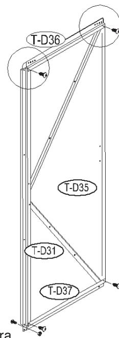
7. Assemblare il profilo (T-D37) alla porta. Assicurarsi di infilare il bordo inferiore della porta nel profilo (T-D37). Fissare (T-D37) a (T-D31) con viti (T-D41). Utilizzare bulloni, dadi e rondelle (T-D43) per fissare (T-D37) alla porta.
