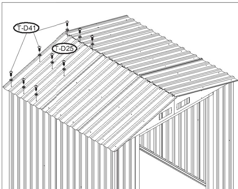
**40.** Posizionare i profili (T-D39) e (T-D38) lungo la copertura. Fissare con viti (T-D41) e rondelle.
