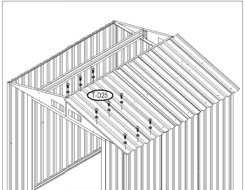
**37.** Posizionare il pannello tetto (T-D23) sopra al timpano (T-D19). Allineare i fori al timpano. Fissare la copertura al timpano con viti (T-D41) e rondelle.
