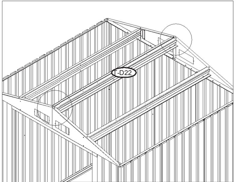
**34.** Posizionare il pannello tetto (T-D23) sopra al timpano (T-D19). Allineare i fori al timpano. Fissare la copertura al timpano con viti (T-D41) e rondelle.
