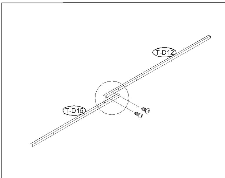
**20.** Posizionare dall'interno la barra assemblata (T-D12) e (T-D15) sulla parte superiore della parete (T-14). Allineare i fori con la parete. Fissare con viti (T-D41) e rondelle.
