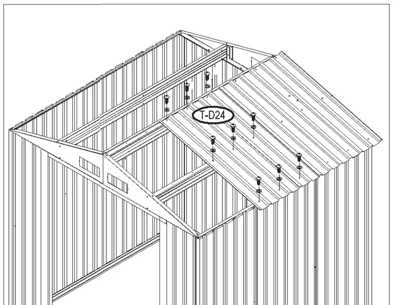
**36.** Posizionare il pannello tetto (T-D25) sopra alla struttura tetto e fissare con viti (T-D41) e rondelle.
