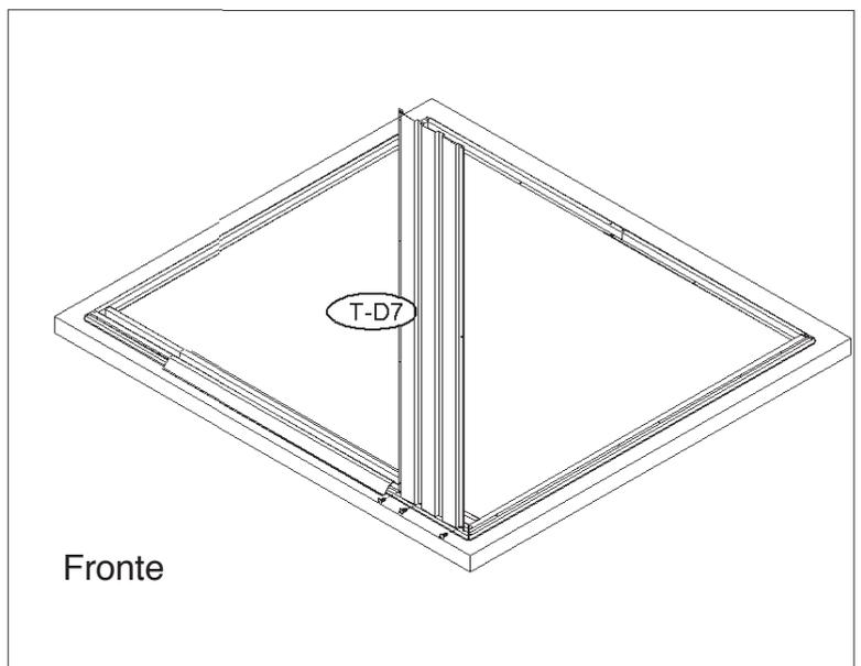
**9.** Posizionare la parete (T-8) in modo da formare un angolo con la parete (T-D7). Allineare i fori della parete con la struttura della base. Fissare dall'esterno con viti (T-D41) e rondelle (T-D40). Utilizzare bullone e dado (T-D43) con rondella (T-D40) per unire le due pareti nel mezzo.
