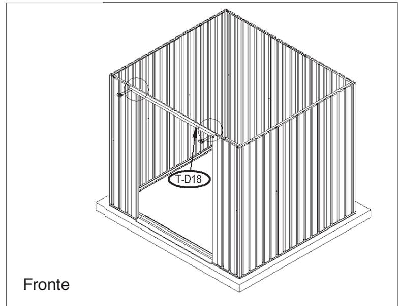
**26.** Posizionare il timpano (T-D19) sopra alla sede di scorrimento (T-D10). Spingere il timpano all'interno dell'angolo lato superiore (T-D13). Allineare i fori con la sede di scorrimento e fissare dall'interno con viti (T-D41).
