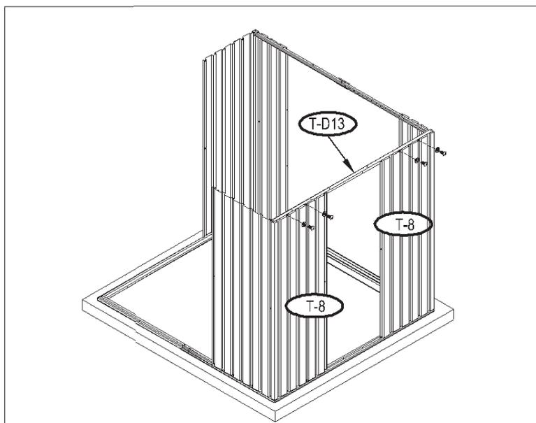
**17.** Posizionare la parete (T-8) in corrispondenza della barra (T-D3). Allineare i fori con la barra e fissare con viti (T-D41) e rondelle.
