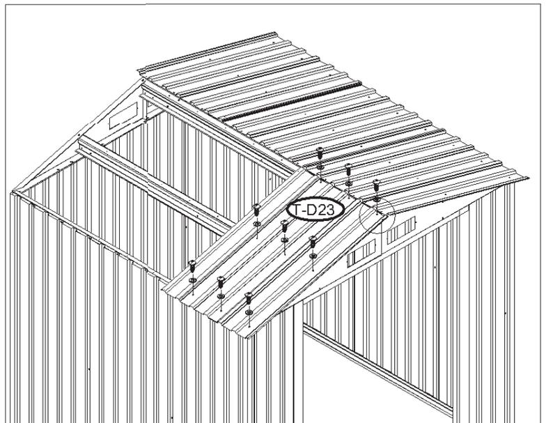
**38.** Posizionare il pannello tetto (T-D24) sopra alla struttura tetto e fissare con viti (T-D41) e rondelle.
