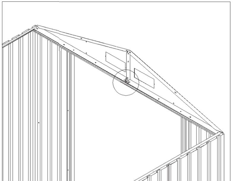
**29.** Posizionare il timpano (T-D19) e (T-D20) sulla parte alta della parete posteriore (T-D12) e (T-D15). Fissare il timpano (T-D19) e (T-D20) con bulloni e dadi (T-D43).
