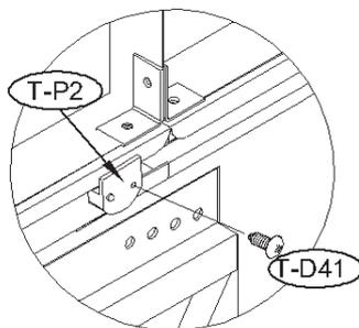
I fori di regolazione permettono di far combaciare in modo uniforme le porte lungo la loro lunghezza
