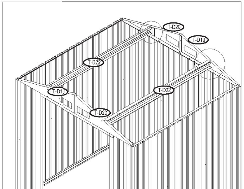
**32.** Assemblare le altre due travi del tetto (T-D22) con bulloni e dadi (T-D43).
