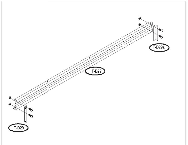
**31.** Fissare la trave del tetto (T-D22) ai timpani (T-D19) e (T-D20). Allineare i fori delle staffe ai timpani e fissare con bulloni, dadi e rondelle (T-D43).
