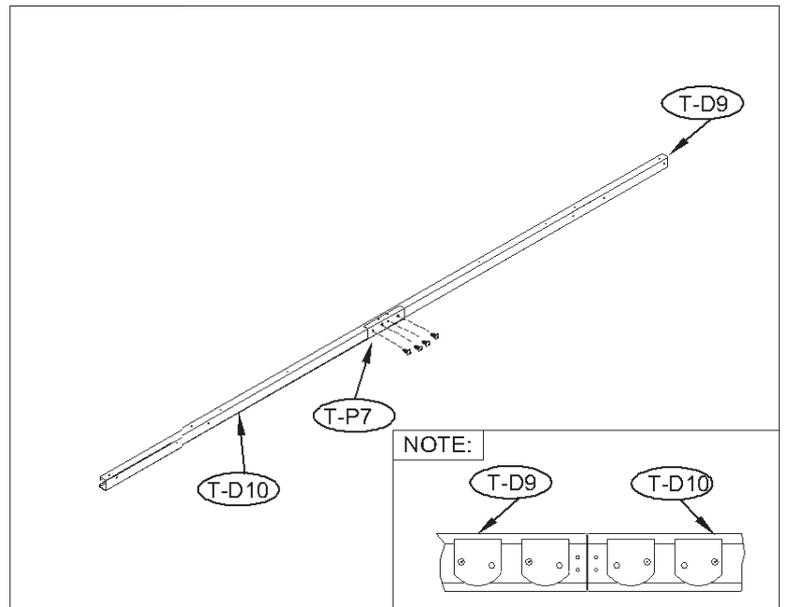
**13.** Posizionare dall'interno la sede di scorrimento (T-D9) e (T-D10) sulla parte superiore della parete (T-D7). Allineare i fori con la parete e fissare con viti (T-D41) e rondelle.
