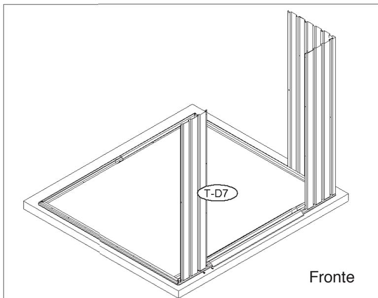
**11.** Posizionare la parete (T-D7) in modo da formare un angolo con la parete (T-8). Allineare i fori della parete con la struttura della base. Fissare con viti (T-D41) e rondelle. Utilizzare bullone e dado (T-D43) con rondella (T-D40) per unire le due pareti nel mezzo.
