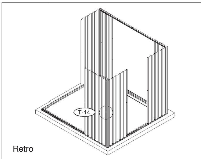
**16.** Posizionare dall'interno la barra (T-D13) sulla parte superiore della parete (T-8) e (T-8). Allineare i fori con la parete. Fissare con viti (T-D41) e rondelle.
