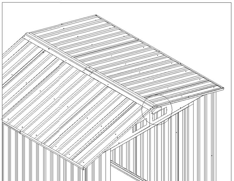
**45.** Posizionare i terminali ad angolo (T-P3) nei punti di giunzione dei profili perimetrali della copertura. Fissare con viti (T-D42) e rondelle.
