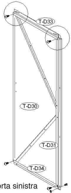
**5. Assemblare il profilo (T-D34) alla porta. Assicurarsi di infilare il bordo inferiore della porta nel profilo (T-D34). Fissare il profilo (T-D34) al profilo (T-D31) con viti (T-D41). Fissare l'altra estremità insieme alla porta ed al profilo (T-D32) con viti (T-D41). Utilizzare bullone e dado con rondella (T-D43) per fissare il profilo (T-D34) alla porta.**
