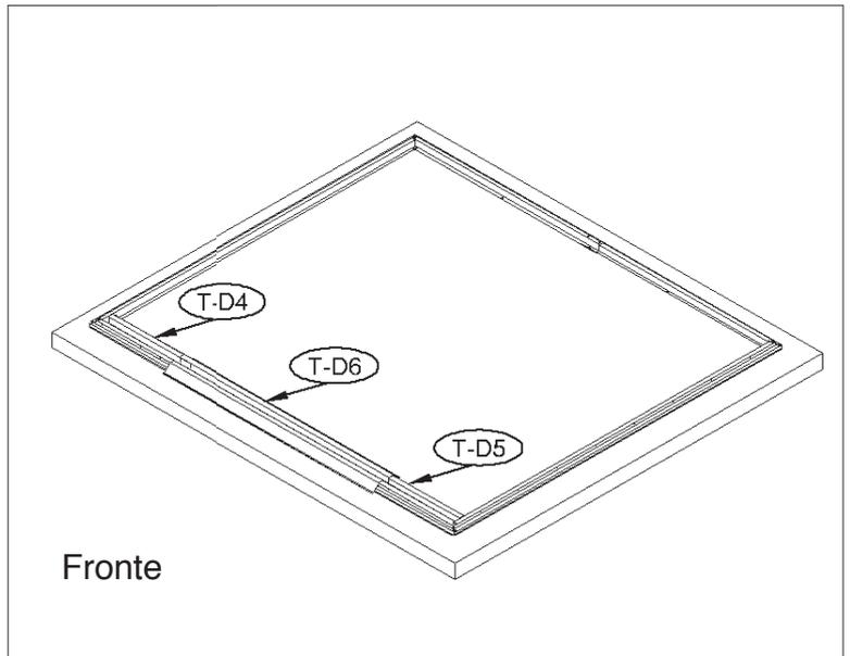
**7.** Posizionate le barre del basamento sulla piattaforma. Fissare le barre alla piattaforma con viti (T-D42)
