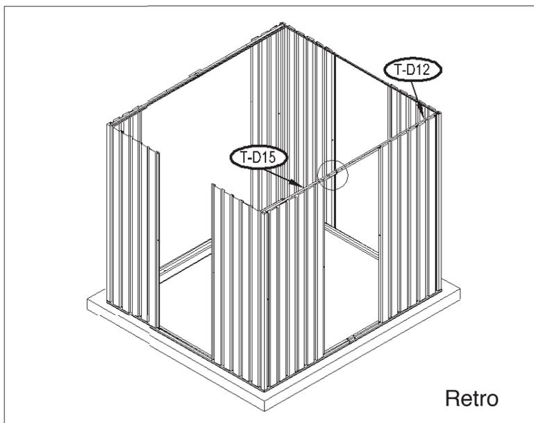
**21.** Posizionare dall'interno la barra (T-D13) sulla parte superiore della parete (T-8) e (T-8). Allineare i fori con la parete. Fissare con viti (T-D41) e rondelle.
