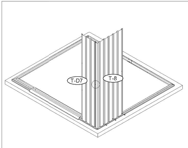
**10.** Posizionare la parete (T-D7) sulla base in corrispondenza della barra (T-D4). Allineare i fori della parete con la barra e fissare con viti (T-D41) e rondelle.
