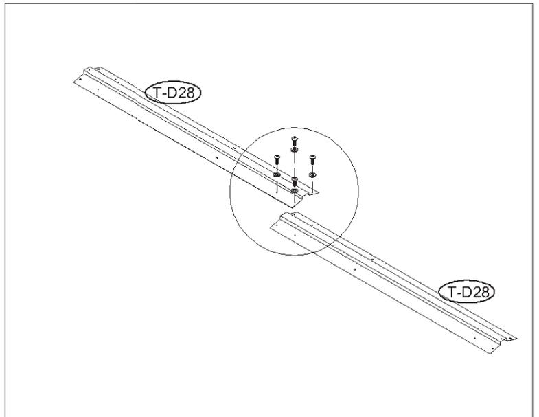
**43.** Posizionare il profilo centrale sul mezzo della copertura. Allineare i fori e fissare con viti (T-D41) e rondelle.
